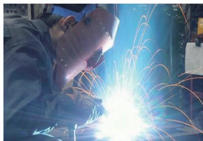
写真 金属アーク溶接と溶接ヒュームの発生状況
