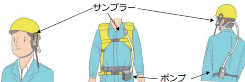
図1 吸引ポンプ法による溶接ヒュームの採取<sup>2)</sup>
