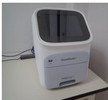
写真1 リアルタイムPCR装置 (QuantStudio 1: Thermo Fisher社)
