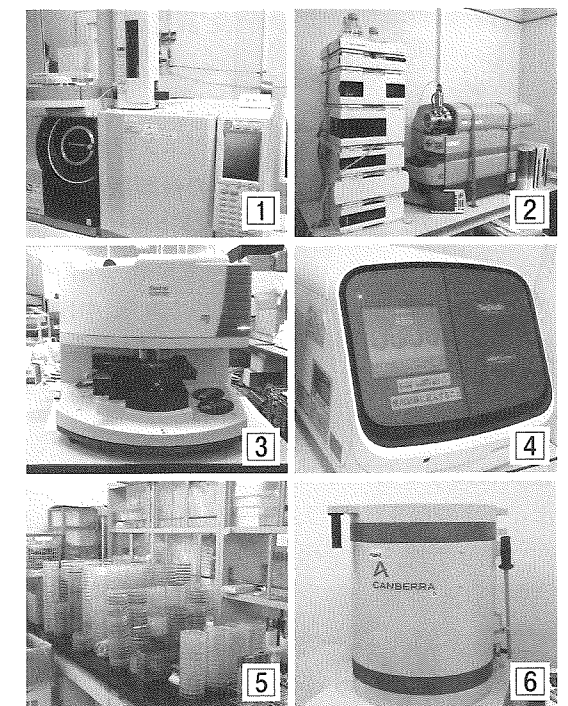
①ガスクロマトグラフ質量分析計 ②液体クロマトグラフ質量分析計 ③FT-IR ④DNAシーケンサー ⑤培地による微生物検査 ⑥放射能測定装置
